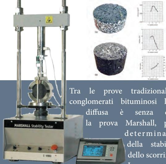
Tra le prove tradizionali nei conglomerati bituminosi la più diffusa è senza dubbio la prova Marshall, per la determinazione della stabilità e dello scorrimento. I campioni
