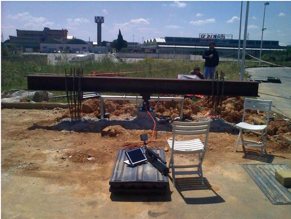
*Fig. 4 – Schema di prova e trave di contrasto*
