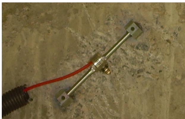
Gli estensimetri (o deformometri) a corda vibrante vengono adoperati per misurare principalmente le deformazioni di elementi strutturali.
